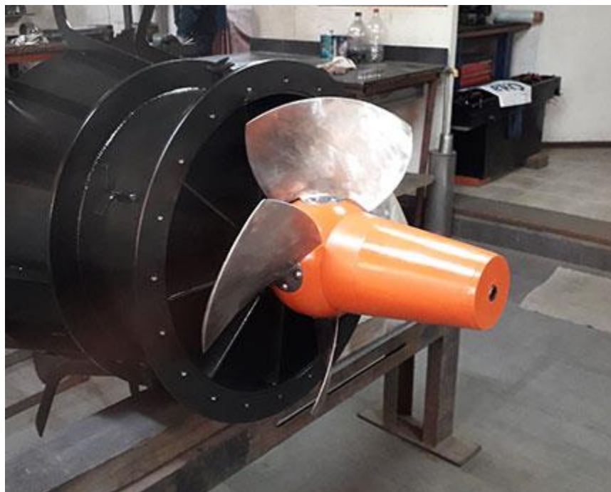
ILUSTRACIÓN 13 TURBINA KAPLAN DE FABRICACIÓN NACIONAL
