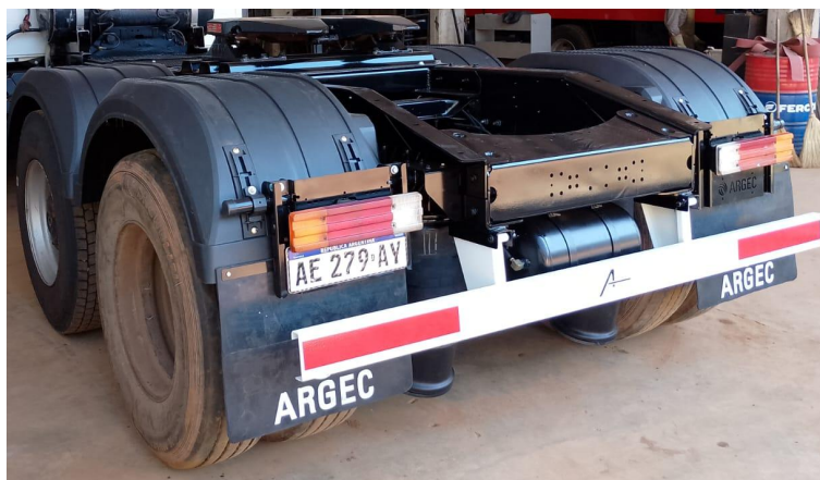
Figura N° 21: Armado de portapatente
