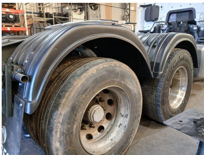
Figura N° 19: Montaje de guardabarros
