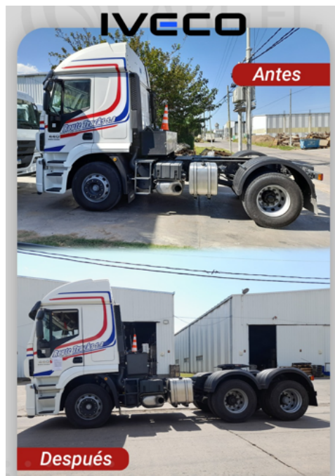
Figura N° 1: Antes y después de la colocación del tercer eje
