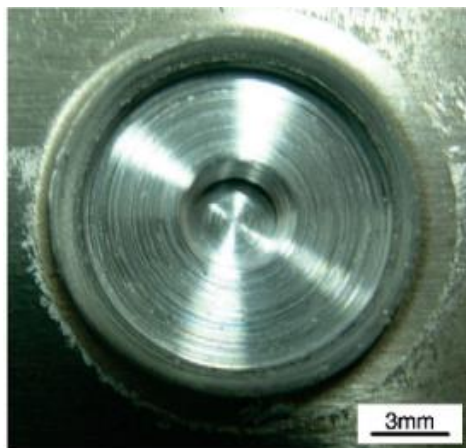
Figura 3: Vista superior de una soldadura FSSW en aluminio 6061-T6 (Wang, 2009).
