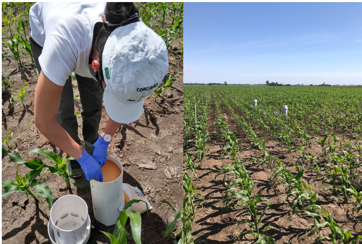
Figura 3. Fotos de las trampas y cambio de esponjas en el experimento.
