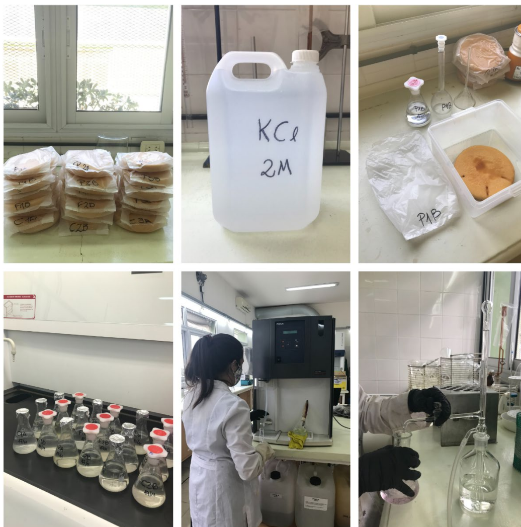
Figura 4. Metodología de extracción de \text{NH}_4^+ en laboratorio.
