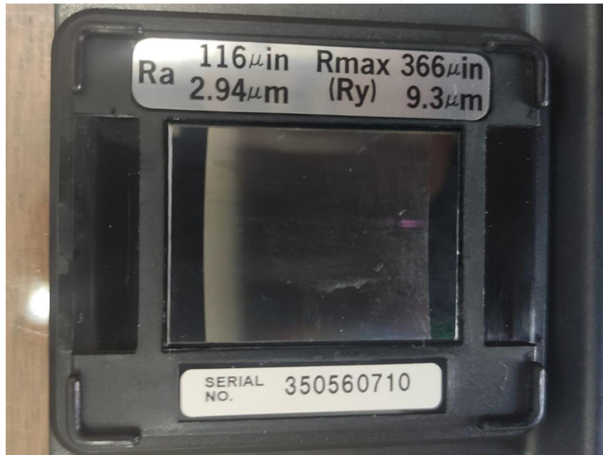
Ilustración 52-Patrón de calibración para el detector de superficie
