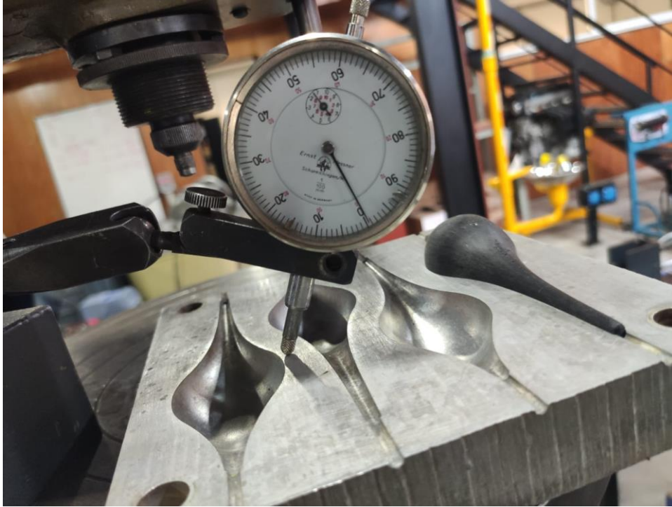
Ilustración 43-Comparación de la superficie mediante comparador/palpador
