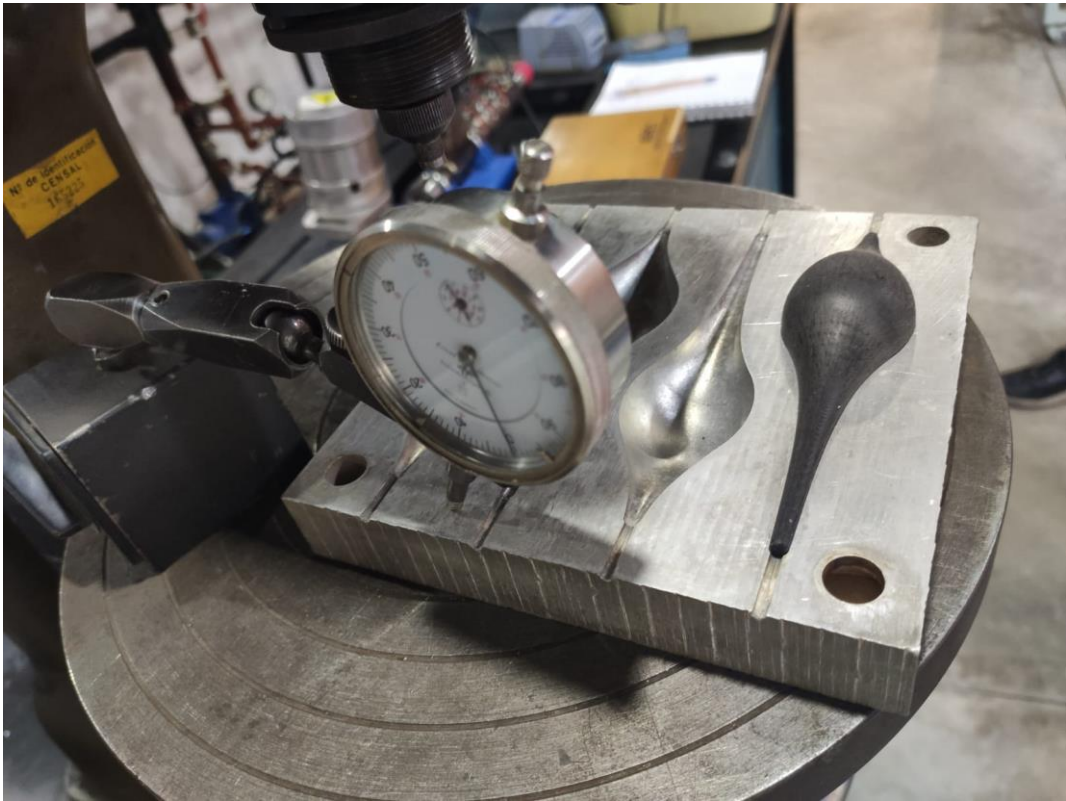
Ilustración 44-Sujetador magnético para agarre del comparador y superficie patrón
