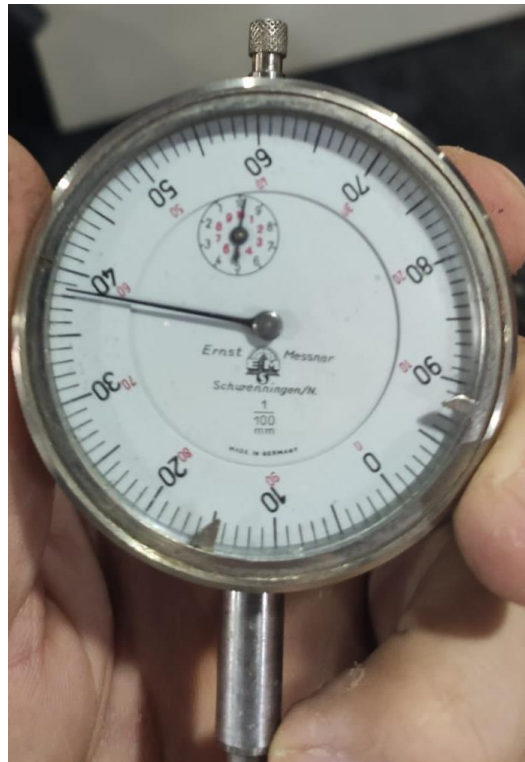
Ilustración 42- Reloj comparador utilizado durante el ensayo
