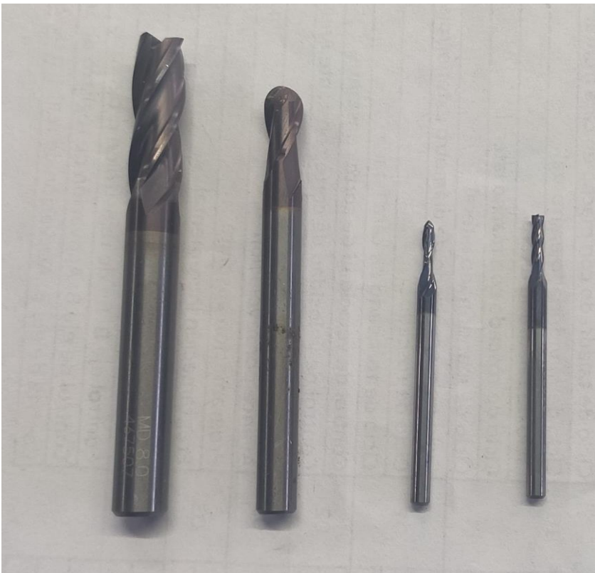
Ilustración 21-Fresas utilizadas para el proceso de mecanizado
