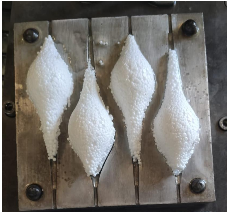
Ilustración 39-Resultado del ensayo cuando soporta la expansión, pero genera rebabas
