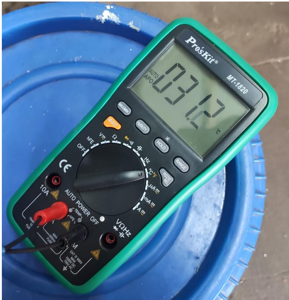
Ilustración 32-Temperatura al inicio del ensayo
