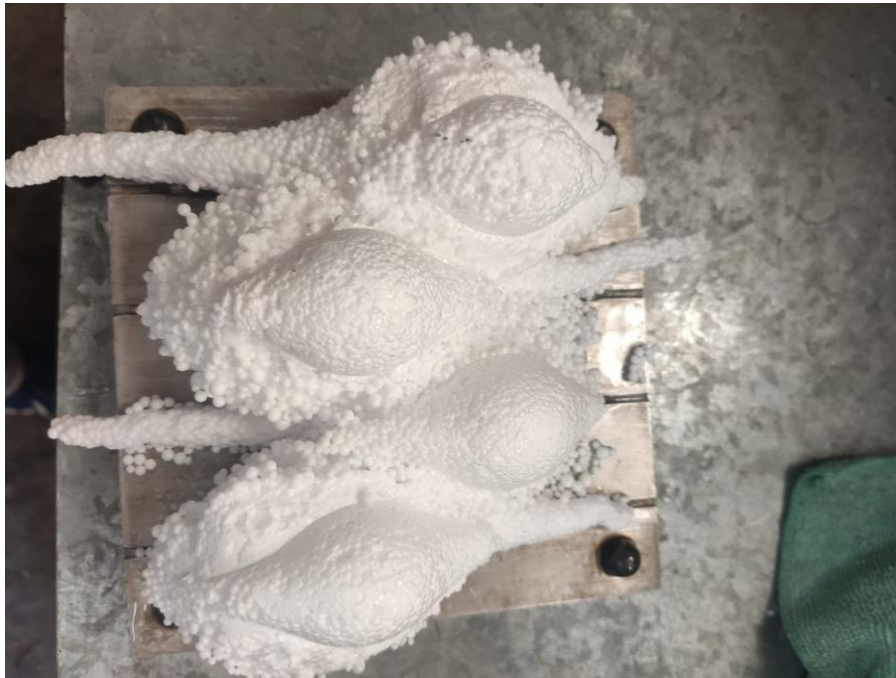
Ilustración 37-Resultado del ensayo cuando no soporta la fuerza de expansión
