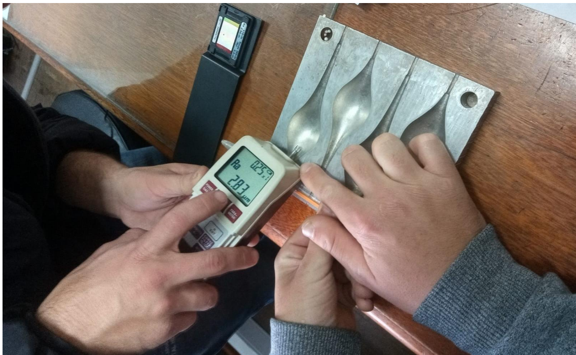
Ilustración 53-Colocación del palpador en la cavidad del molde
