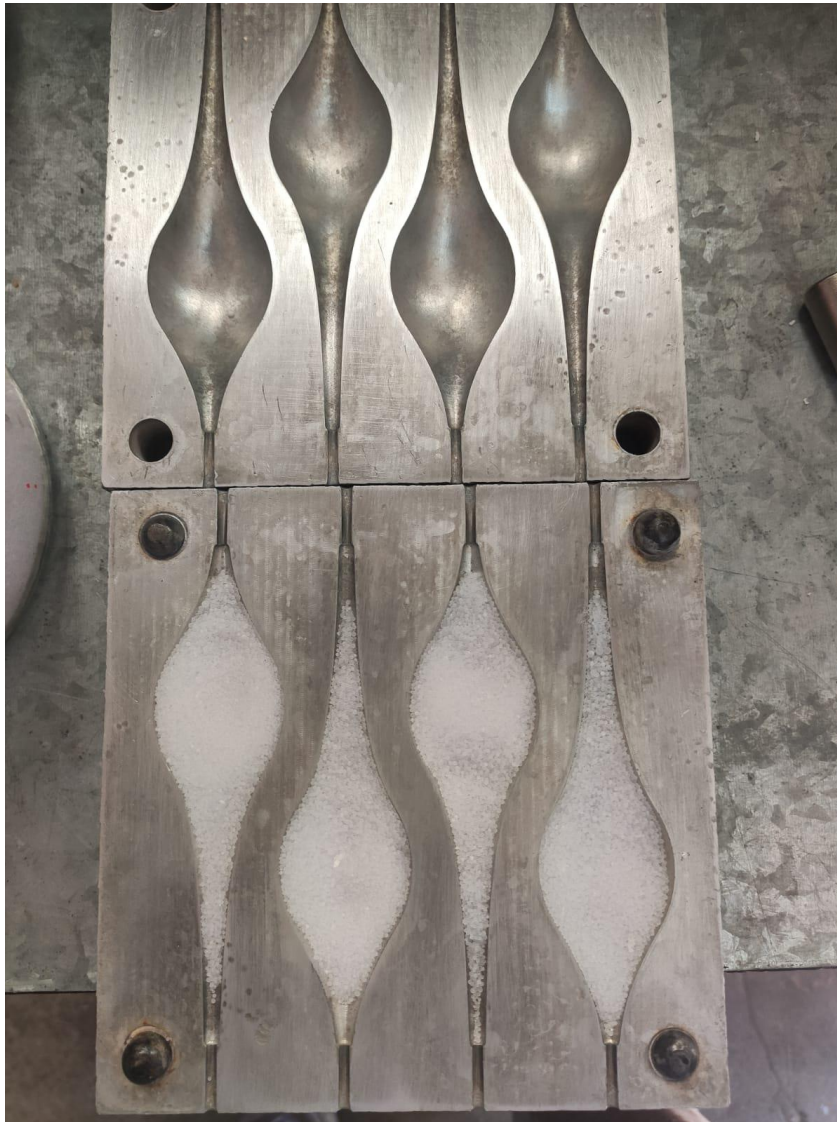
Ilustración 35-Carga y preparación de la matriz antes del ensayo
