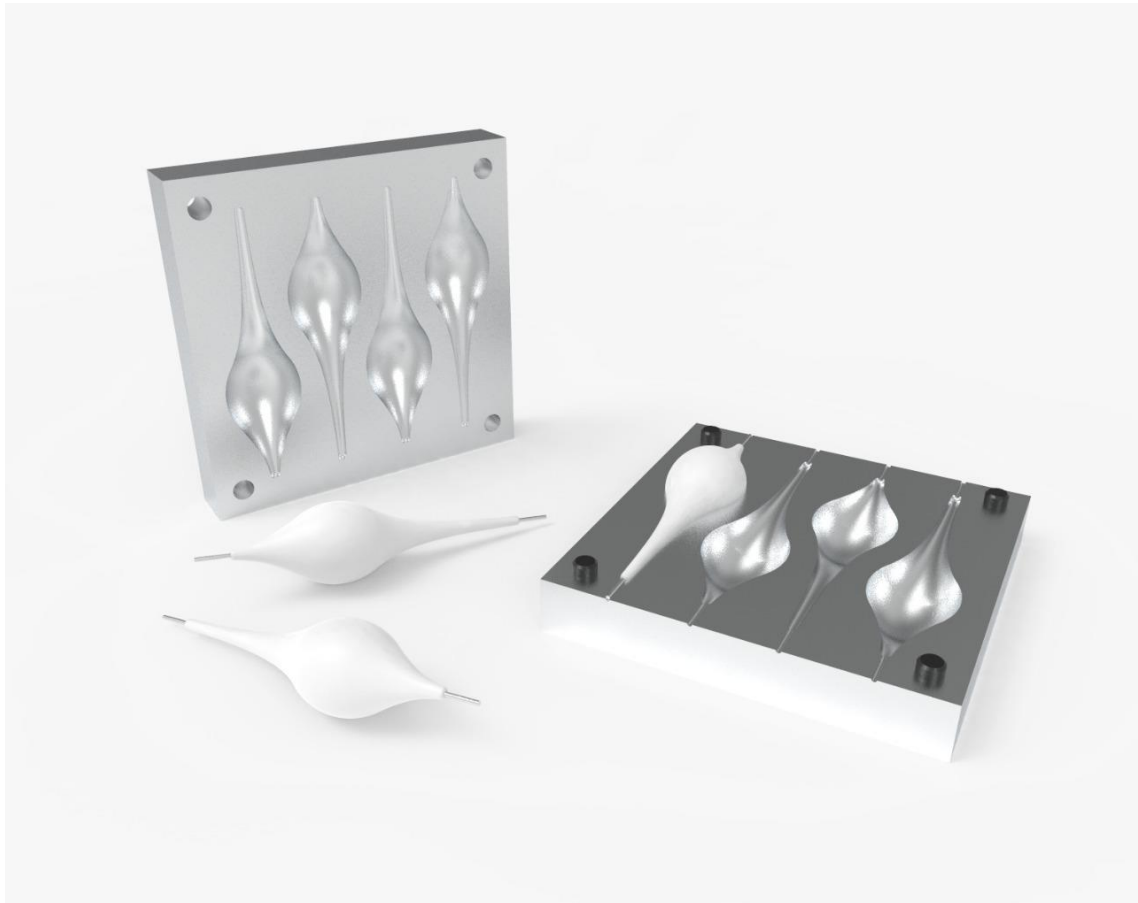
Ilustración 29-Render de SolidWorks de la matriz pensada
