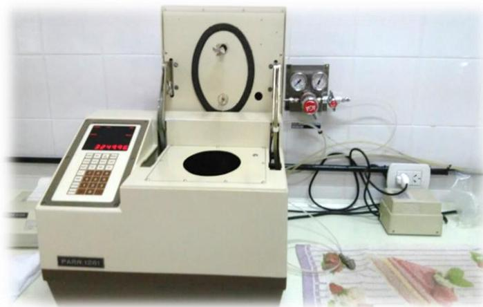
**Figura 5.** Calorímetro isoperibólico.
