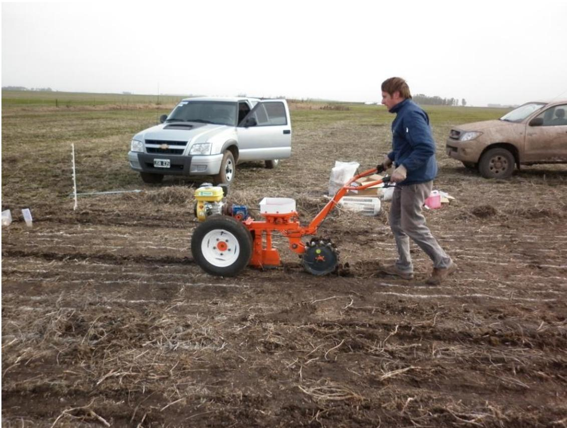
Figura N°3. Sembradora autopropulsada.
