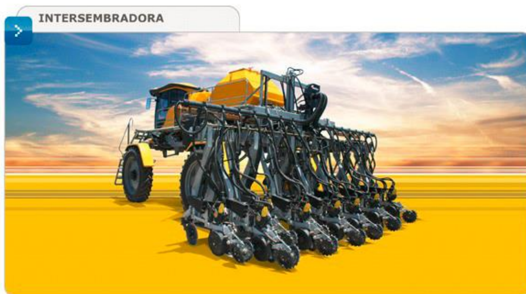
Figura 2: Prototipo de sembradora para intercultivos realizado por la firma PLA.
