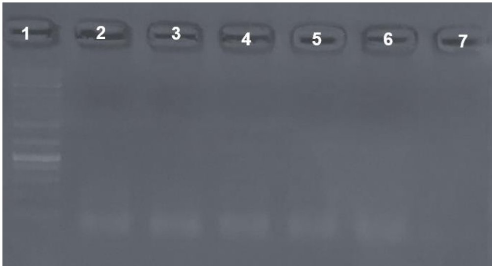
Figura 11: Corrida electroforética en gel de agarosa 2 % con 90V durante 30 minutos. Calle 1) Marker; Calle 2) 56°C; Calle 3) 58°C; Calle 4) 60°C; Calle 5) 62°C; Calle 6) 64°C; Calle 7) control negativo a 60°C.
