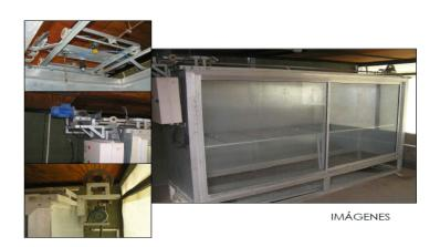
Con los planos ya realizados se procedió a contactar a un Carpintero en Aluminio en la ciudad de Pergamino, donde se comenzó a construir la estructura que forma parte de la Cámara de Pulverizado. Su construcción se realizó en Aluminio y en su parte frontal cuenta con una ventana de vidrio corrediza.
