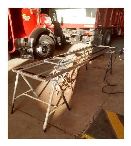
El Carro Pulverizador es quién transporta al aplicador y al recipiente que contiene el producto a asperjar. El mismo es accionado por un tablero eléctrico y circula por rieles, desplazándose a una velocidad constante de un extremo a otro del riel.
