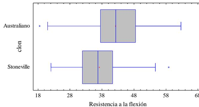
Figura 7: Resistencia a la flexión en  $N/mm^2$
