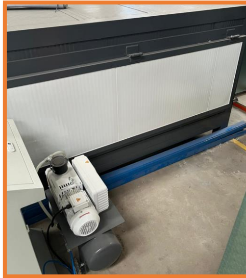
Ilustración 4. Ubicación de Bomba de Vacío. Fuente: Elaboración propia.
