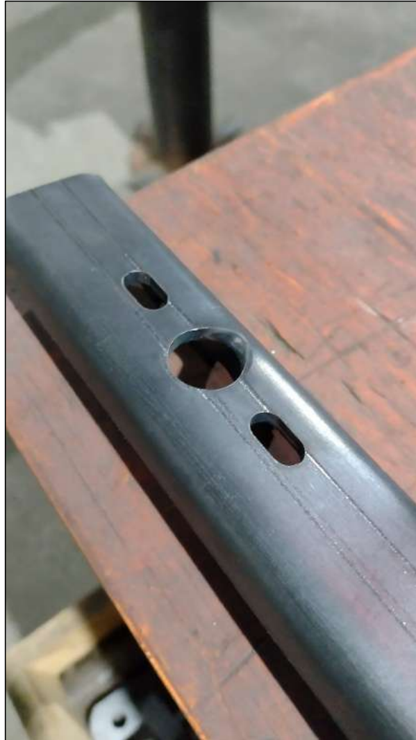
Ilustración 32: Error en el prototipo ocasionado durante el proceso de plegado
