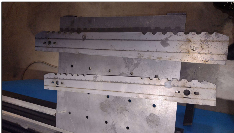
Ilustración 31: Barras de acarreador ya cortadas con la maquina laser
