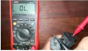
Figura 4. Procedimiento de medición de continuidad de las masas con multímetro
