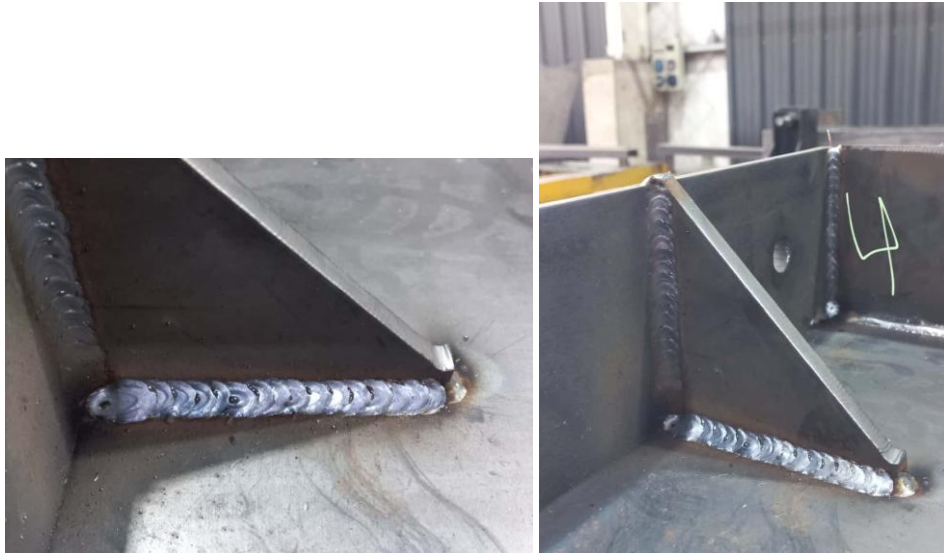
Ilustración 24 - Unión refuerzos columna Buenos Aires. Fuente: Elaboración propia.
