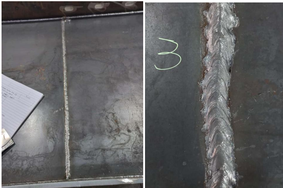
Ilustración 22 - Unión alma-alma columna Buenos Aires. Fuente: Elaboración propia.
