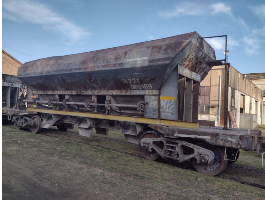
Imagen 38- Tolva con sistema de descarga de rampa móvil.
