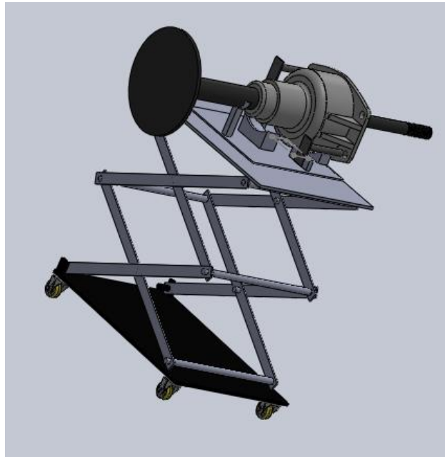
Imagen 21- Sistema tipo tijera para elevación de paragolpe y caja.
