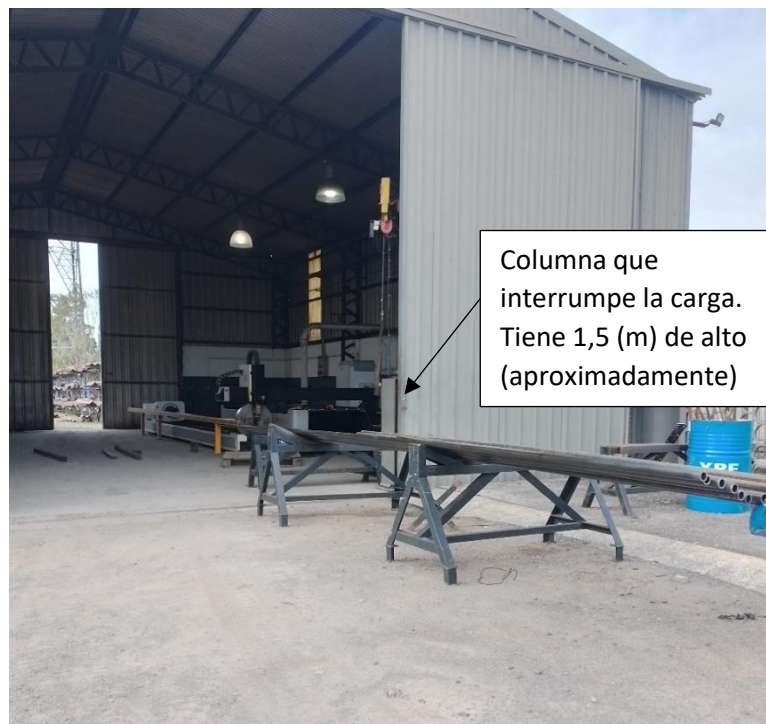
Ilustración 9. Representación de una de las problemáticas principales al momento de cargar materiales a la máquina que se utiliza actualmente.
