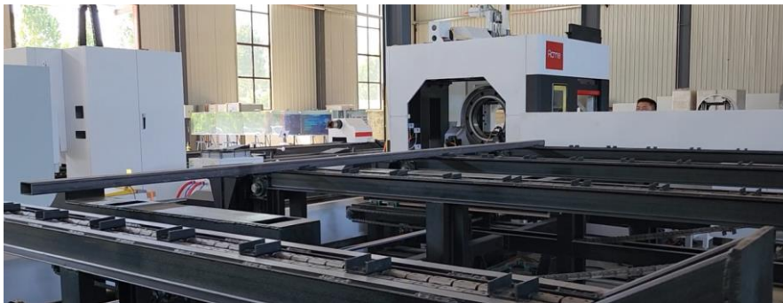
Ilustración 11. Una de las primeras soluciones pensadas para cargar materiales. Fuente: Torres Americanas S.A.
