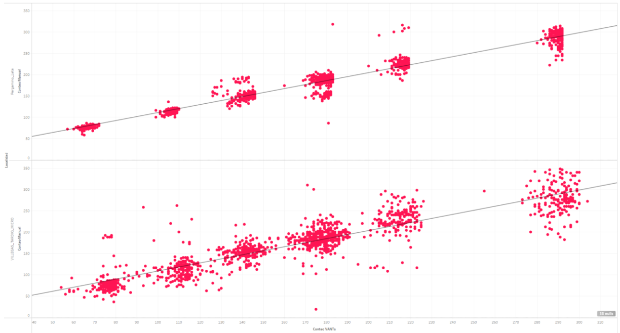
Figura 9. Grafica de análisis regresión lineal entre el conteo de plantas de maíz en micro parcelas (17.88m 2 ) por el método VANTs y el conteo de humano, en ambas localidades de Pergamino y General Villegas. Correlación de 0.89 r 2 .
